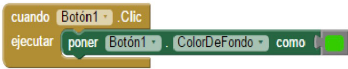
Figura 35. Código del cambio de color de un botón cuando haga clic el usuario. Elaborado por autores. 2015.
