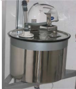
Fotografía 3. Tanque de acidificación con agitador de paleta
