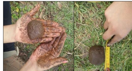
Figura 5 prueba de textura de suelo
