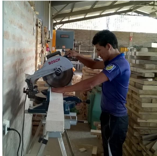
Corte de probetas
