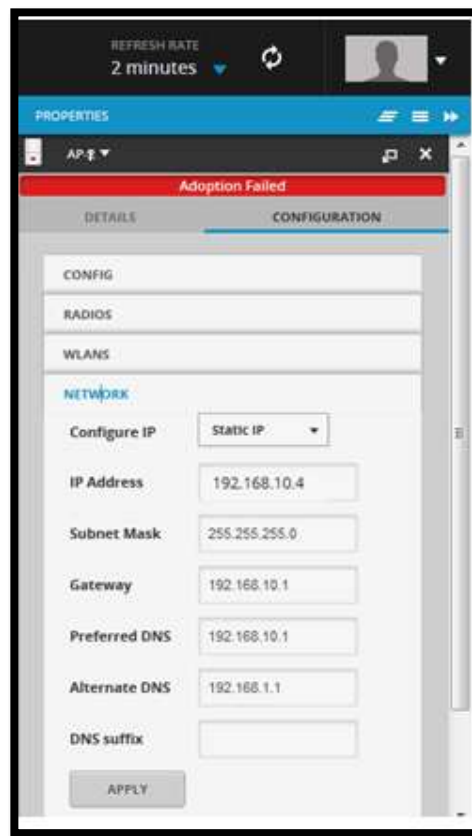
Figura 39. Configuración Access point Complejo Santa Clara Fuente: Recuperado de Software Ubiquiti
