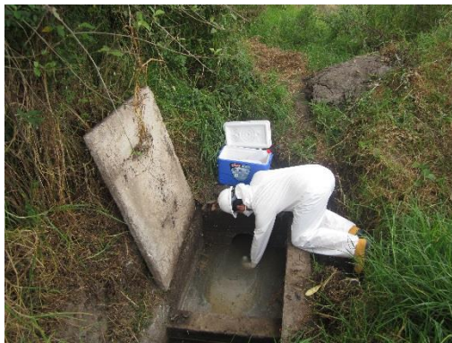
Fotografía 3. Toma de muestra simple Planta de tratamiento Cahuasqui
