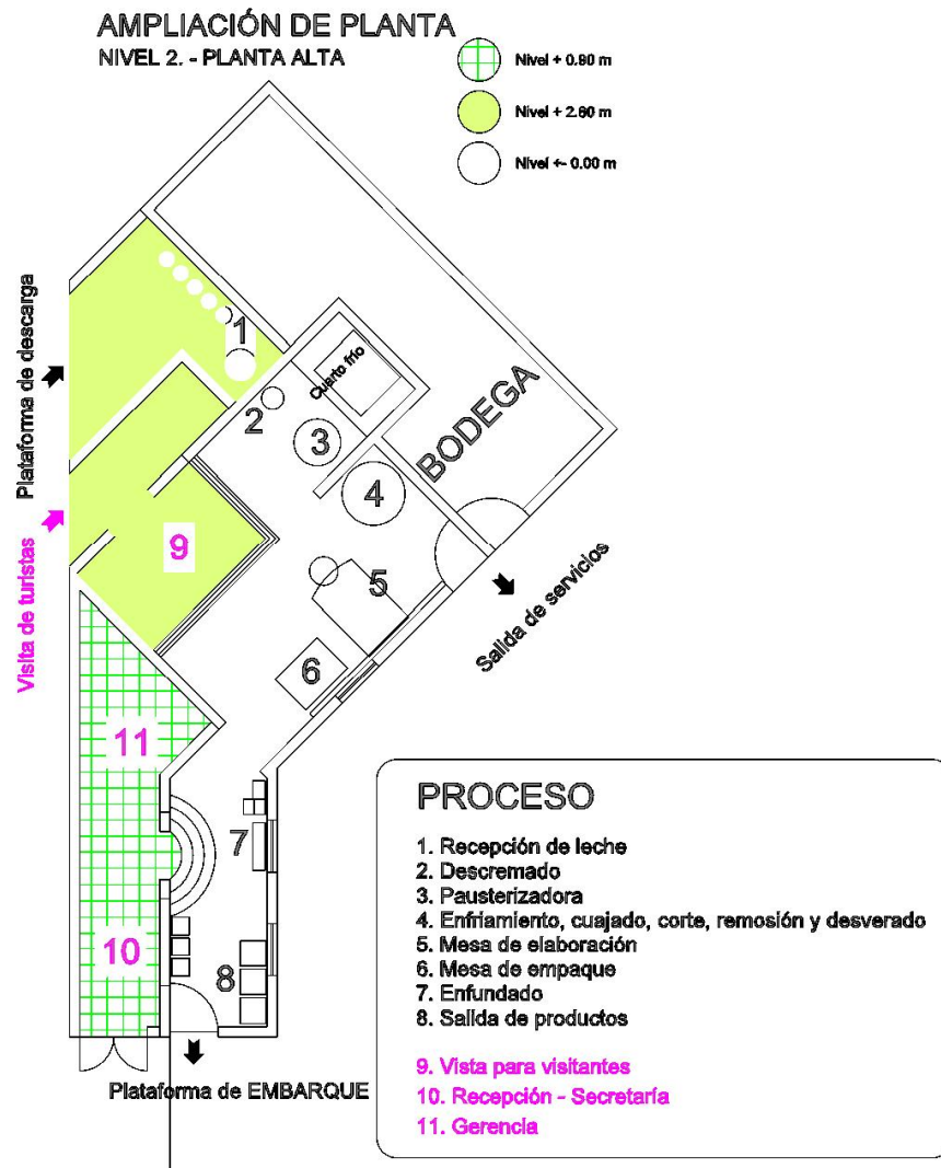
Ilustración N°. 26 Distribución planta –Ampliación 2
