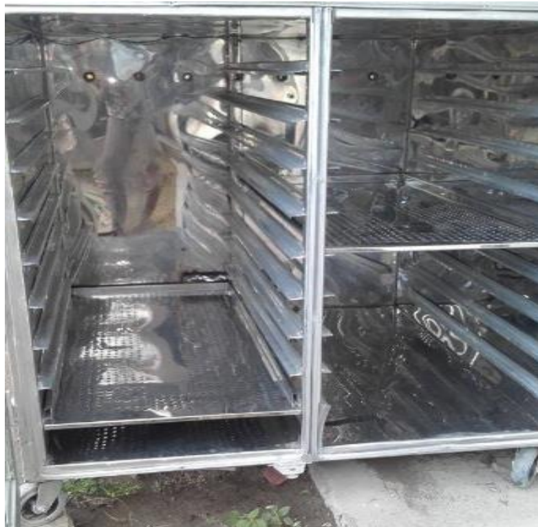
Figura 5. 5 Estructura interna del secador
