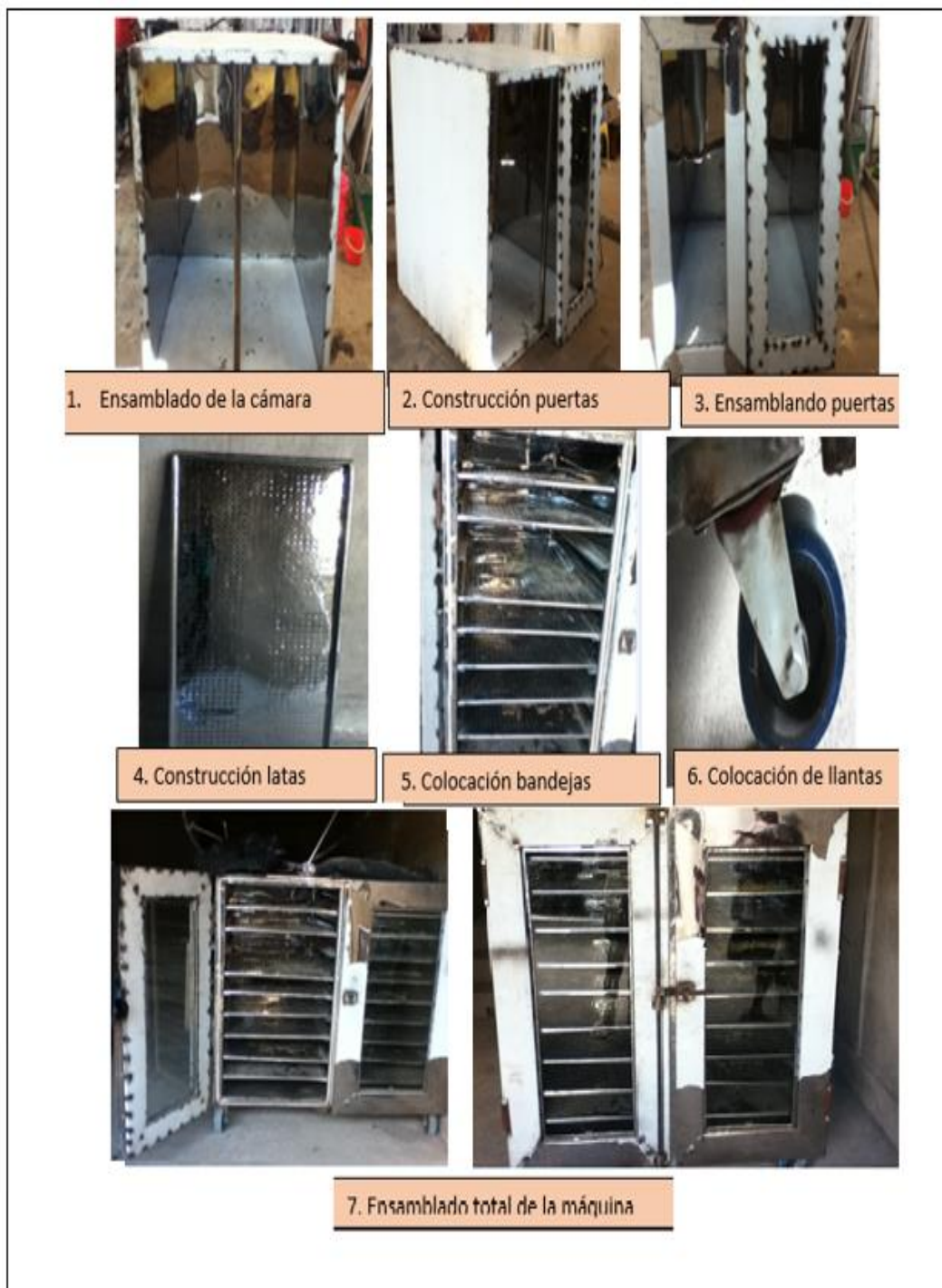
Figura 4. 19 Proceso de ensamblado del secador de bandejas
