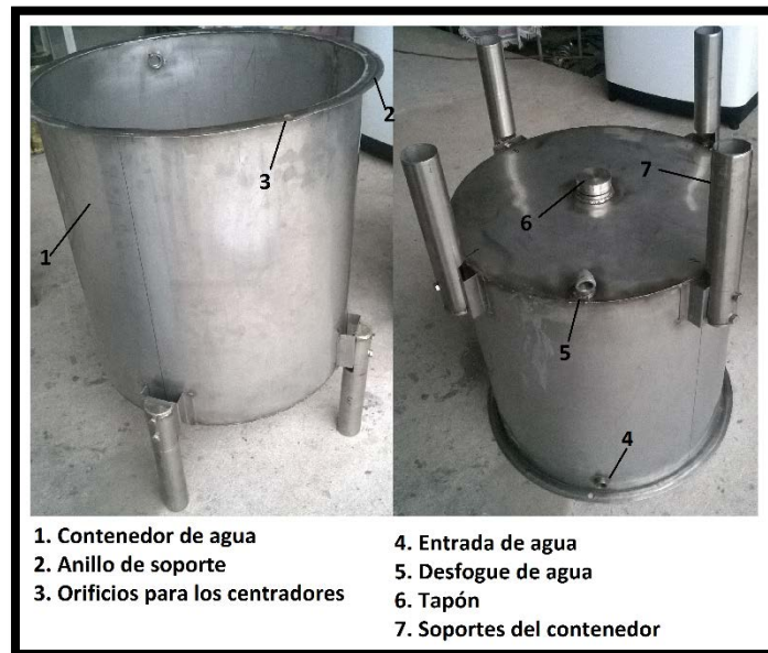
Figura 3.40 Contenedor de agua
