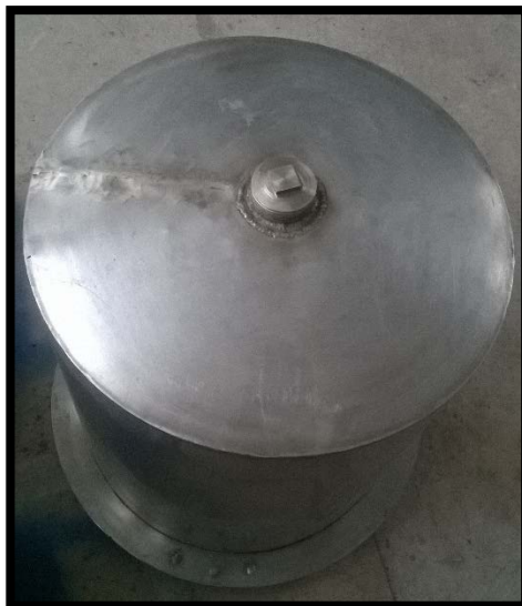
Figura 3.39 Orificio para acondicionamiento de una bomba
