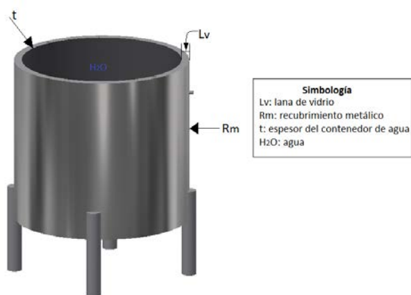
Figura 3.20 Contenedor de agua
