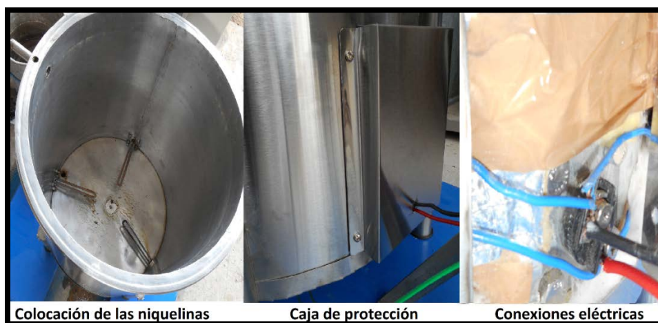
Figura 3.49 Colocación de las niquelinas
