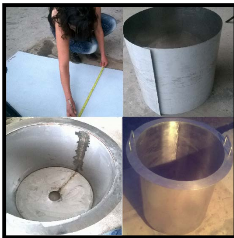
Figura 3.37 Proceso de manufacturación del contenedor de leche
