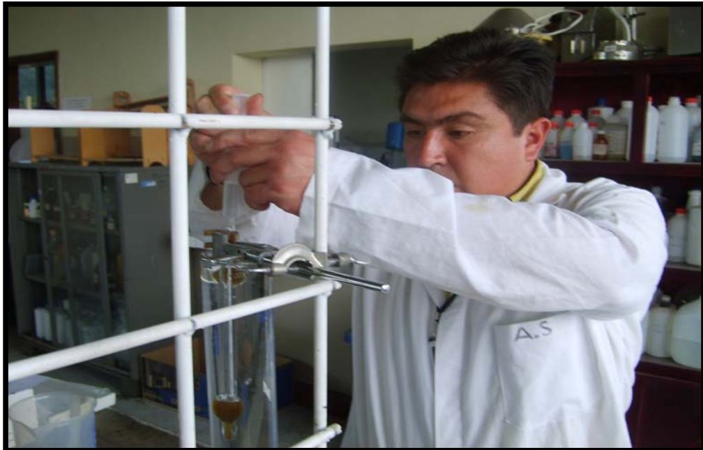
Análisis de la viscosidad de los aceites esenciales.
