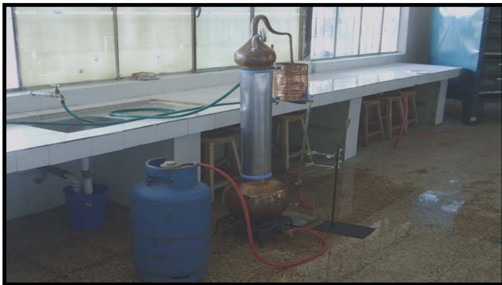
Alambique Tipo Cachimbo por cohobación
