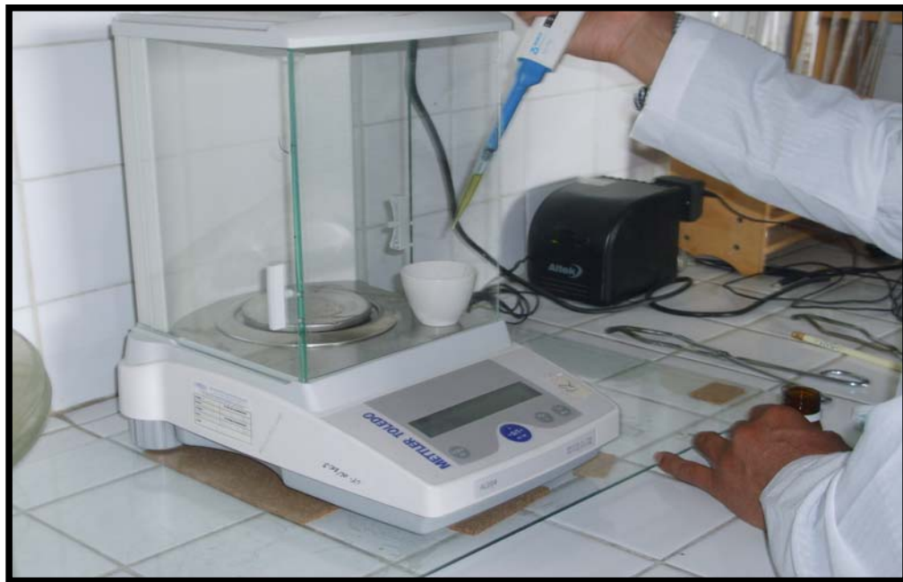
Análisis del residuo no volátil de los aceites esenciales.
