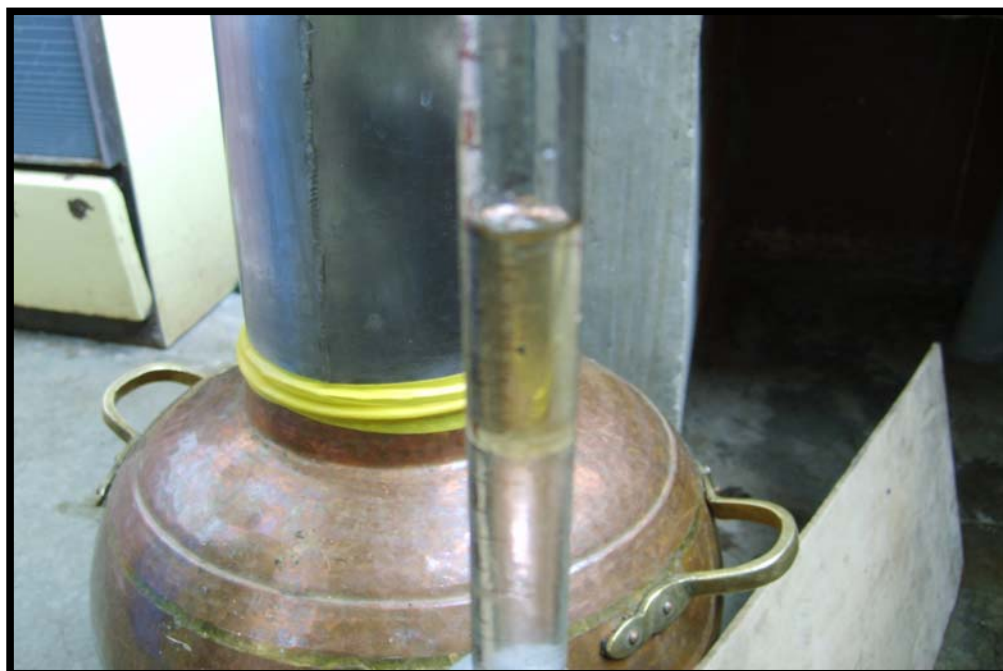
Extracción de los aceites esenciales.
