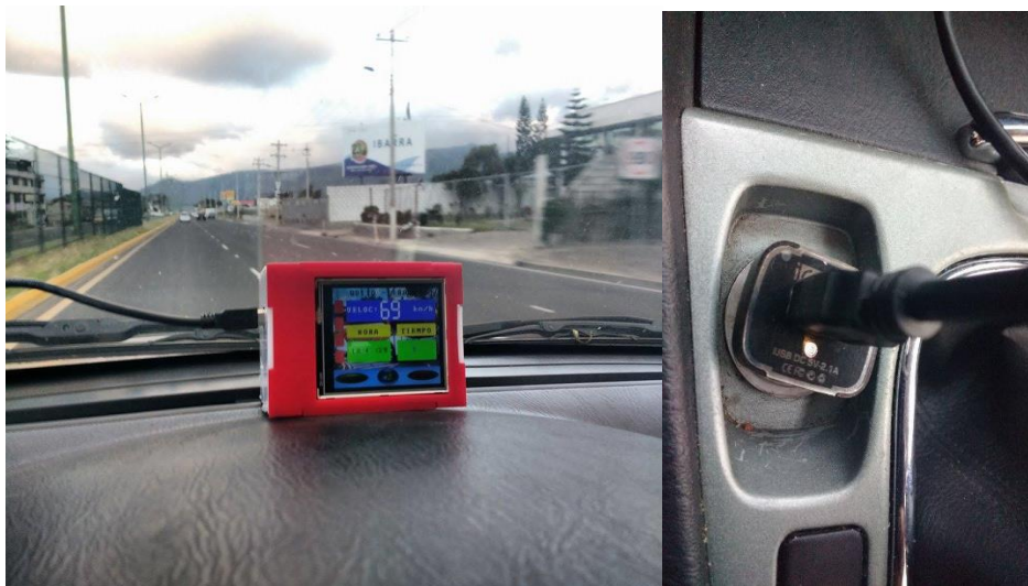
Figura 65. Instalación del dispositivo.
