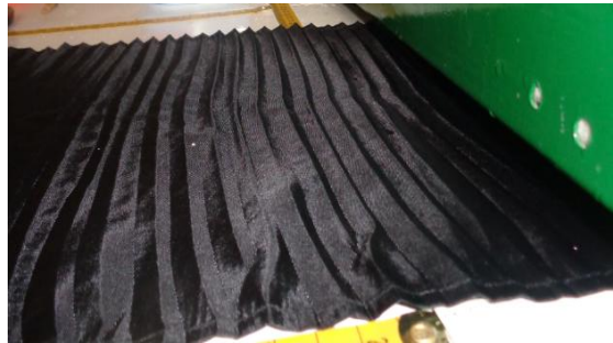
Figura 4.16: Resultado de la prueba con tela poliéster.
