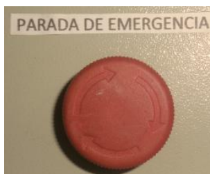
Figura 28: Parada de emergencia.
