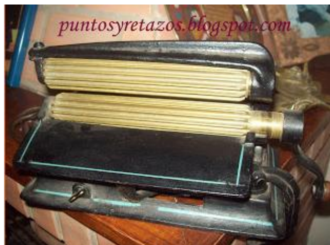
Figura 2.8: Máquina para plisar tela tipo artesanal. Fuente: Miriam E. (2013).
