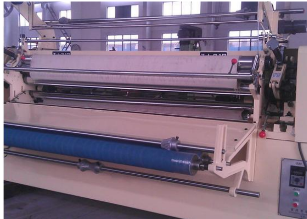
Figura 2.7: Máquina para plisar tela tipo industrial. Fuente: Semai (2013).
