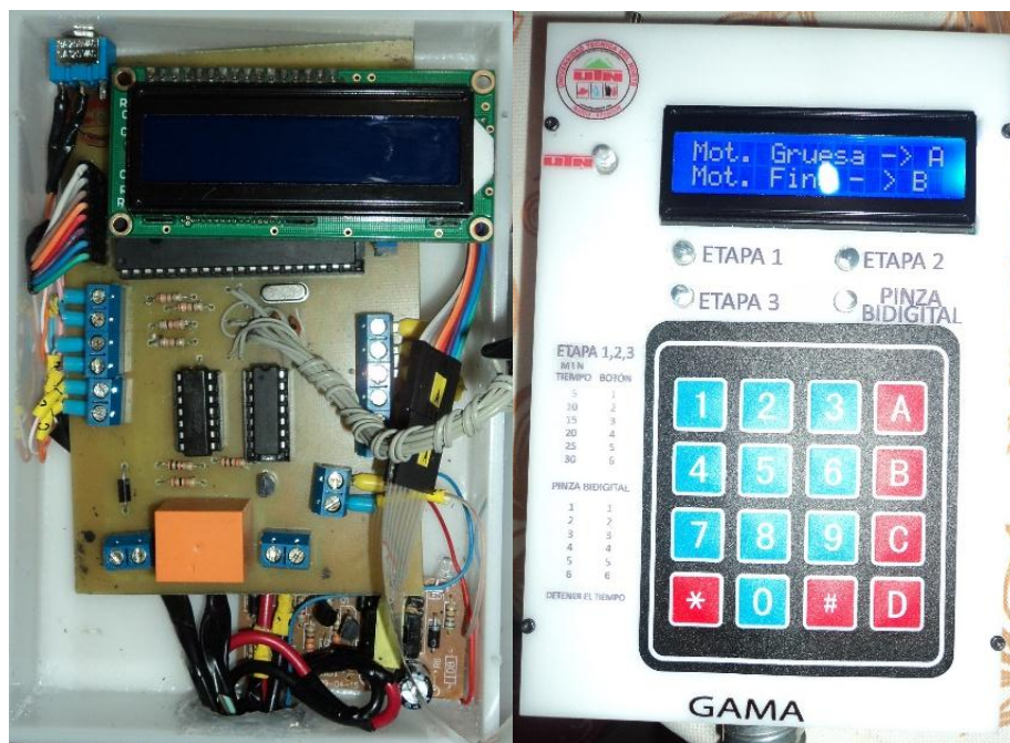
Figura 2.10: Tablero de mando implementado
