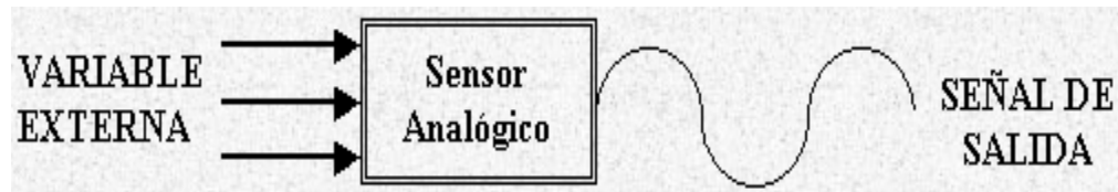
FIGURA Nº. 2 Diagrama de funcionamiento de un sensor analógico
