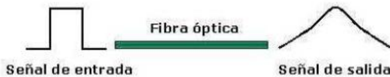
Figura 9. Dispersión den una fibra óptica.
