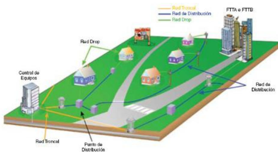
Figura 11. Segmentos de una PON.
