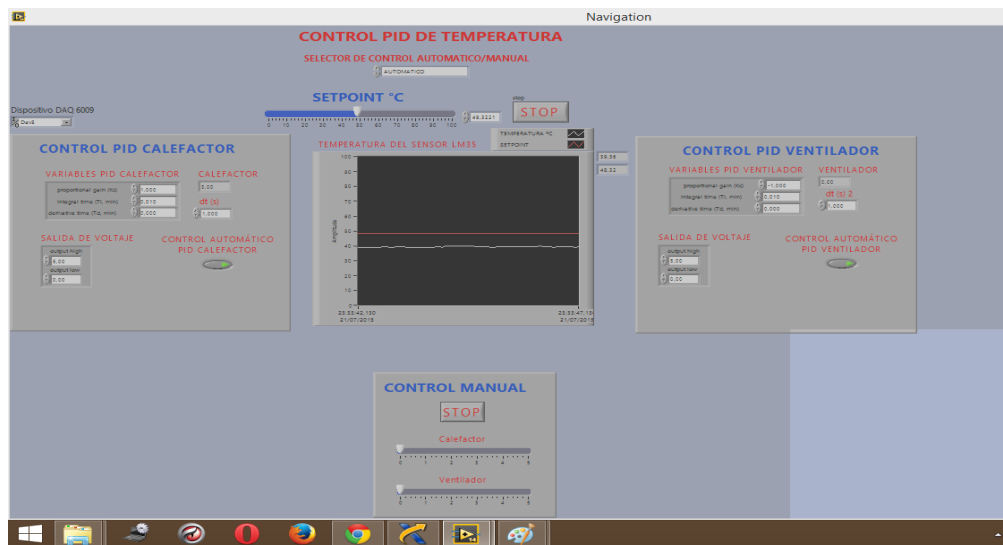
Figura N° 89 Panel frontal del módulo de temperatura.
