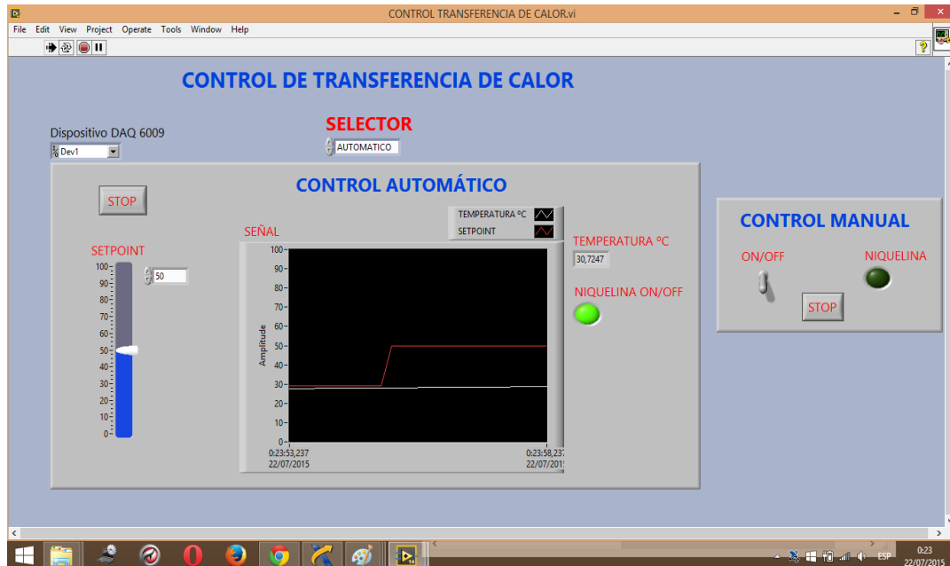
Figura N° 114 Panel frontal de transferencia de calor en Labview.
