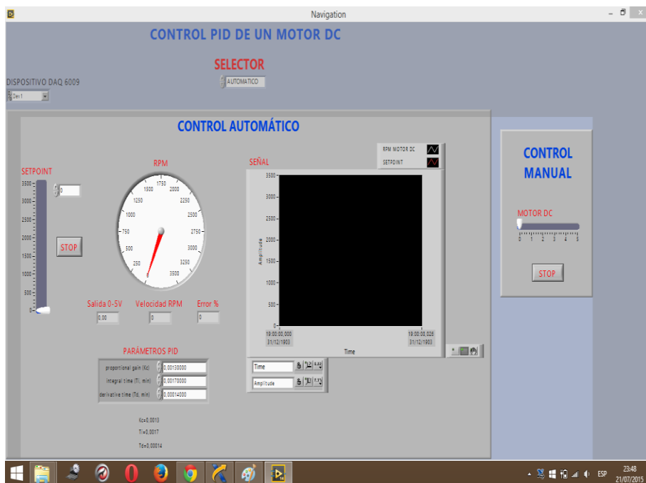
Figura N° 57 Visualización del panel frontal para el control de velocidad.
