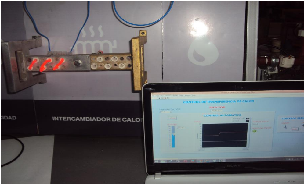
Figura N° 117 Funcionamiento del hardware con interfaz en labview mediante PID.
