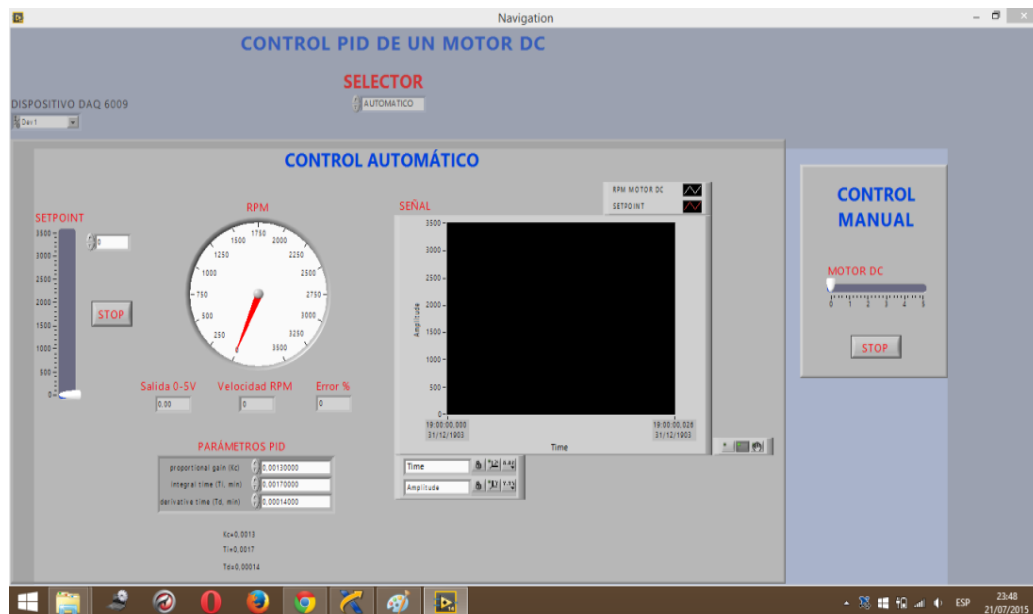
Figura N° 124 Visualización del panel frontal para el control de velocidad.
