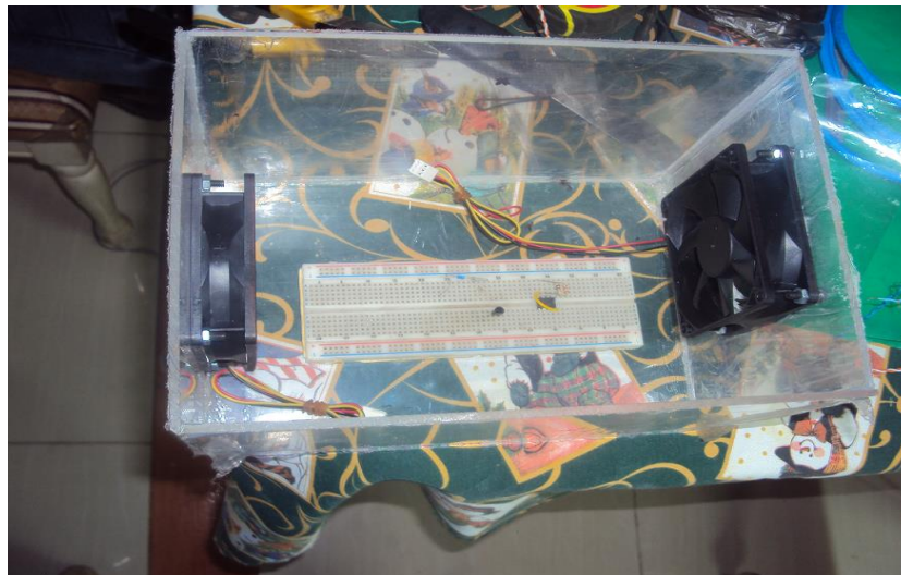
Figura N° 80 Armazón de la caja de mica con los ventiladores
