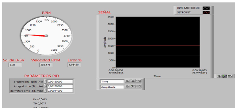
Figura N° 128 Funcionamiento del software mediante PID
