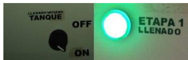
Figura 4.24: Selección etapa de llenado del tanque
