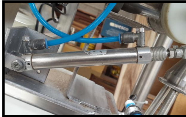
FIGURA 2.46 Cilindro neumático para apertura válvula de dosificación
