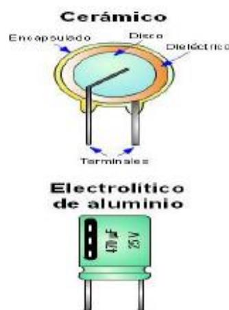
*Figura 7. Tipos de condensadores
