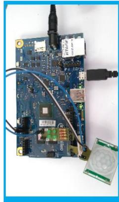
*Figura 24. Funcionamiento del sensor PIR*
