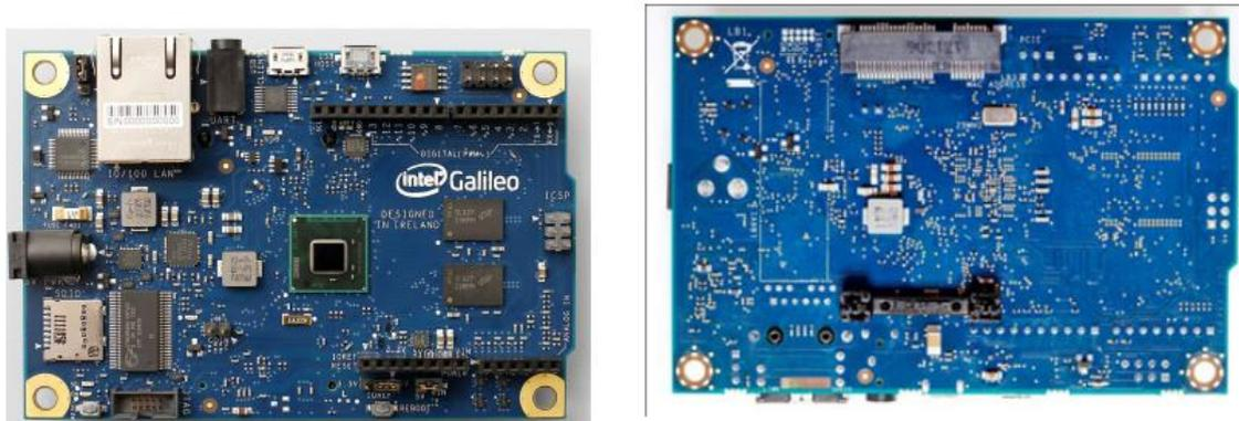
*Figura 16. Vista frontal y posterior de la Placa Intel Galileo Gen 2
