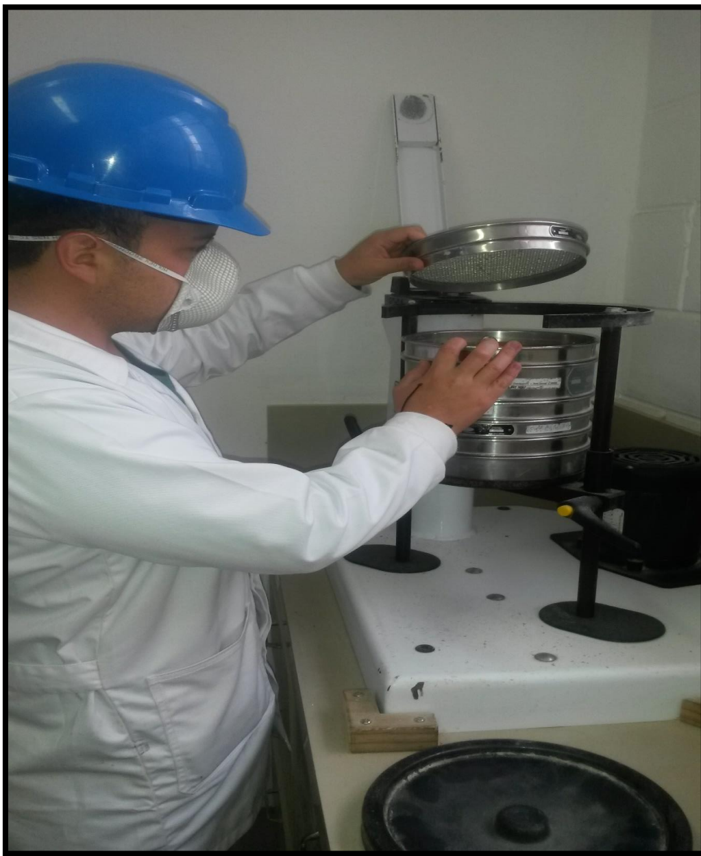
Fotografía 2.- Determinación de granulometría de la mezcla. Laboratorio físico, Planta de alimentos balanceados Puenbo, junio 2014.
