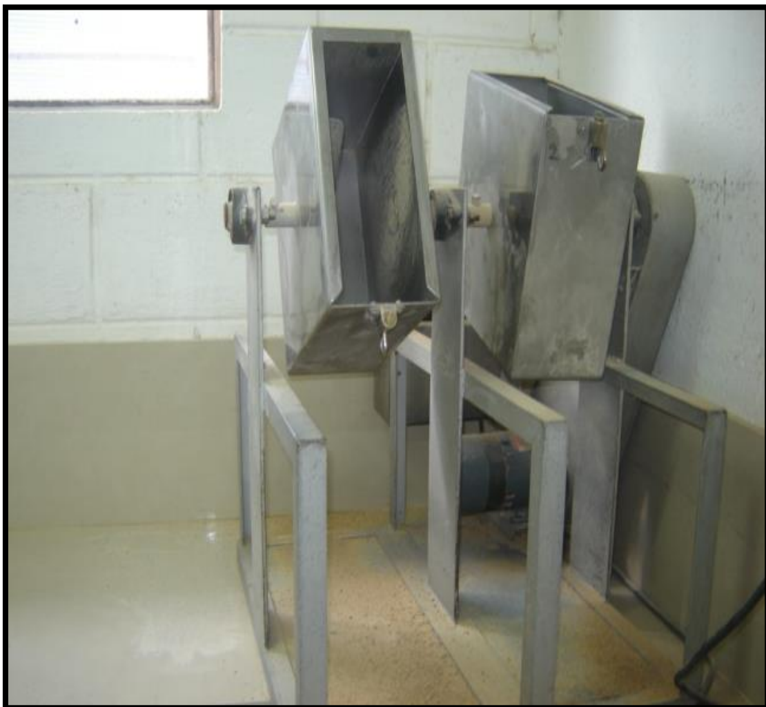
Fotografía 3.- Pdiómetro para la determinación del índice de durabilidad de pellet (PDI) normal y modificado. Laboratorio físico, Planta de alimentos balanceados Puenbo, junio 2014.
