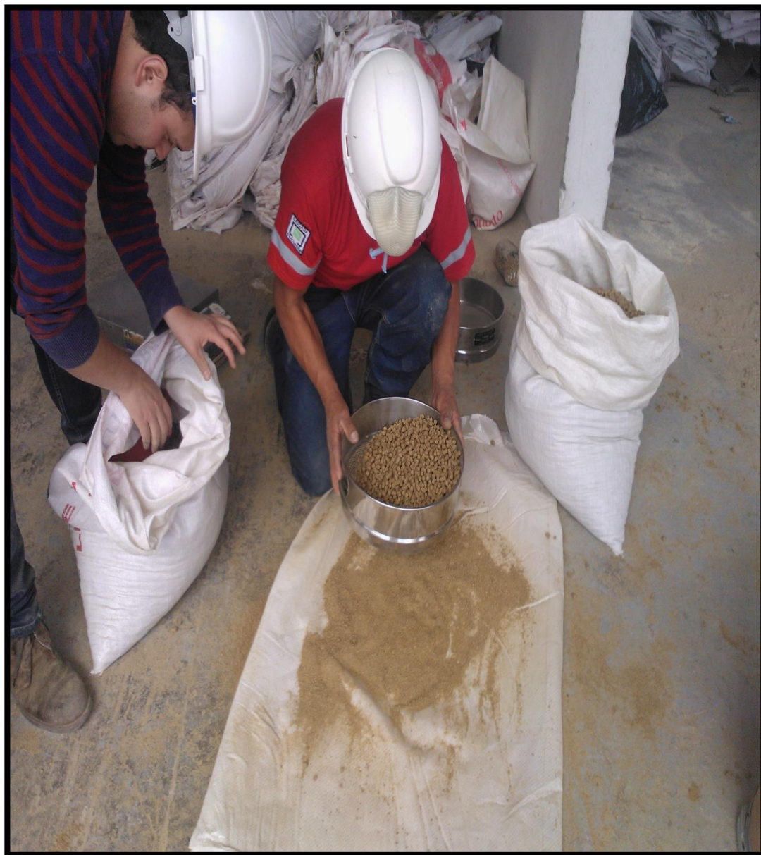
Fotografía 5.- Determinación del contenido de migajas y finos del producto terminado. Laboratorio físico, Planta de alimentos balanceados Puenbo, junio 2014.
