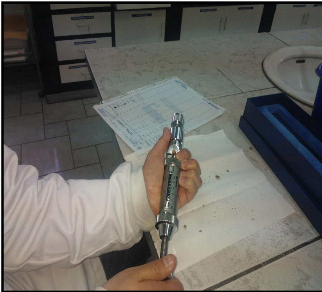
Fotografía 4.- Determinación de dureza del pellet con el durómetro. Laboratorio físico, Planta de alimentos balanceados Puenbo, junio 2014.
