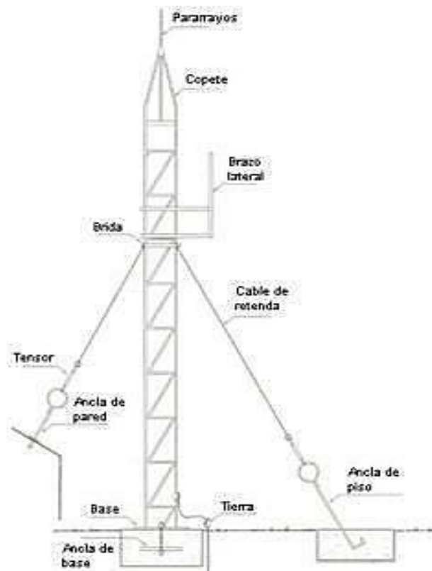
Figura 115. Partes de una torre soportada por tirantes
