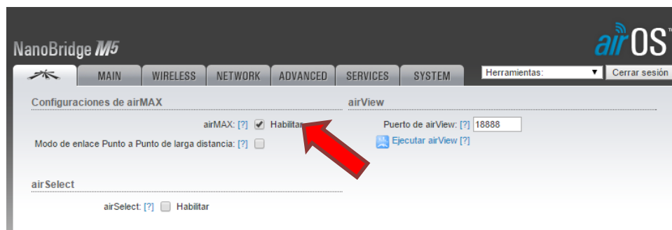
Figura 58. Visualización configuración protocolo Airmax, Equipo Ubiquiti Modo Access Point, Enlace Terraza UTN-Lomas de Azaya
