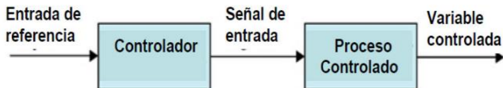
Figura 1.9. Sistema de control en lazo abierto.
