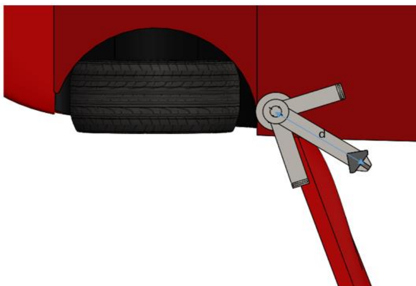
Figura 2.1. Distancia entre la ubicación de la gata y el dispositivo de elevación.
