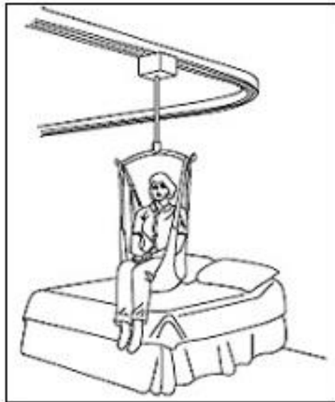
Figura 1.2. Grúa de techo.
