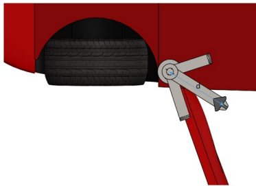
Figure 2. Distancia entre la ubicación de la gata y el dispositivo de elevación.
