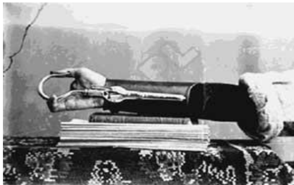
Figura 1. 3: Prótesis de mano con pulgar móvil y gancho dividido sagitalmente Fuente: J. Dorador, 2004.
