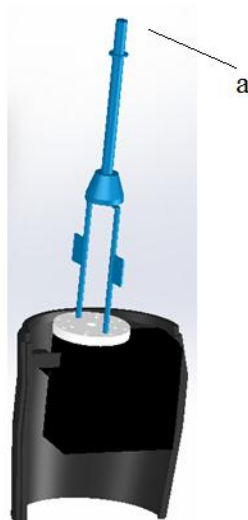
Figura 2. 11: a) Rosca del eje de acero inoxidable Fuente: Autor
