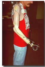
Figura 7: Prótesis Híbrida Fuente: C. Arce, 2005.
