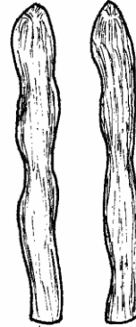
Muy irregular (no tolerable)
