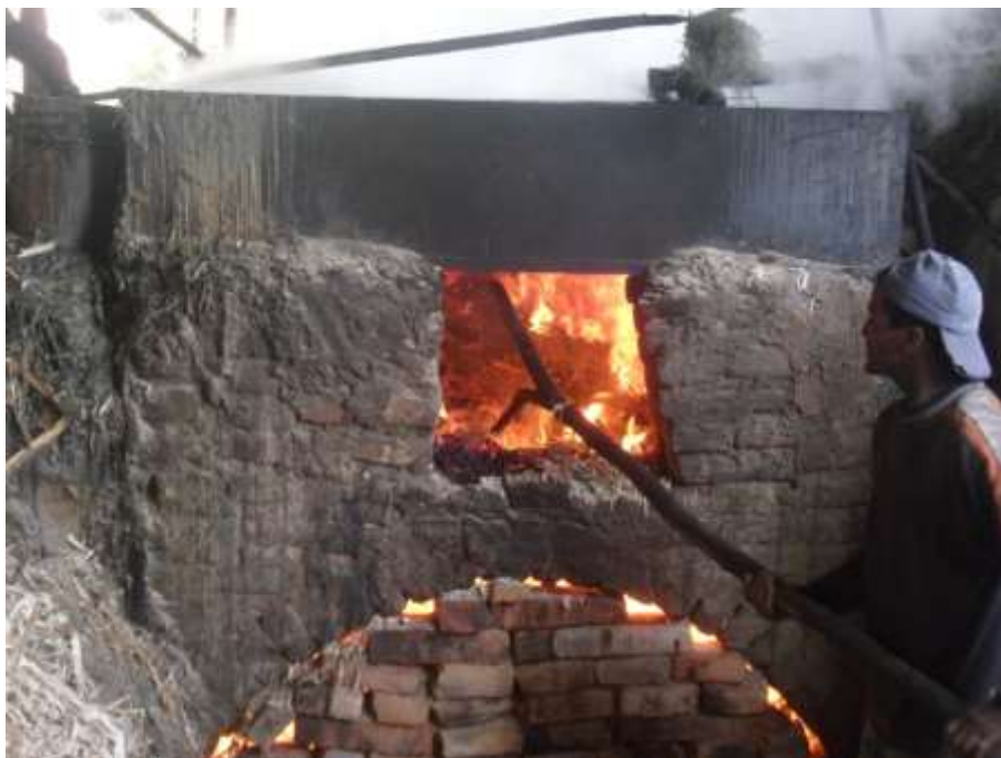
Ilustración 50: Alimentación de bagazo a la cámara de combustión.
