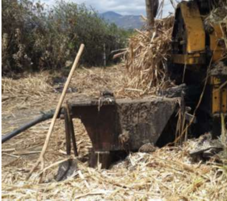
Ilustración 26. Filtro de prelimpieza del jugo de caña.
