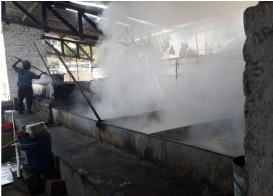
Ilustración 33: Tinas de evaporación
