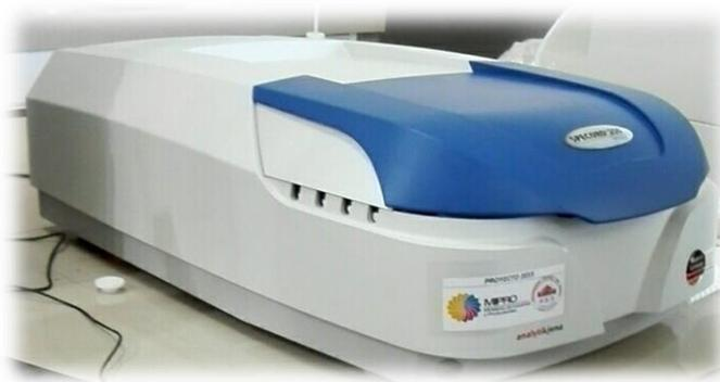
Figura 13. Espectrofotómetro de reflectancia: color reflejado y porcentaje de saturación
