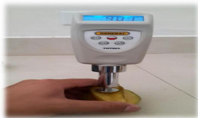
Figura 14. Penetrómetro – medición de firmeza
