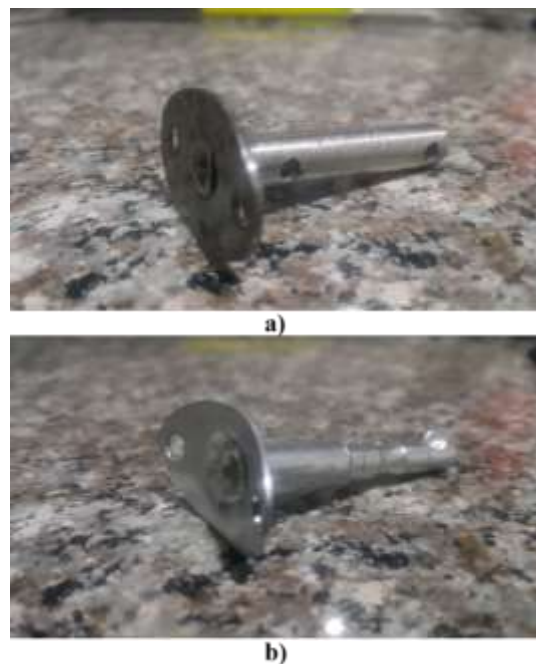
Figura 44. Pieza para ligar la sección 4 con la unión 1. a) nueva pieza b) pieza original
