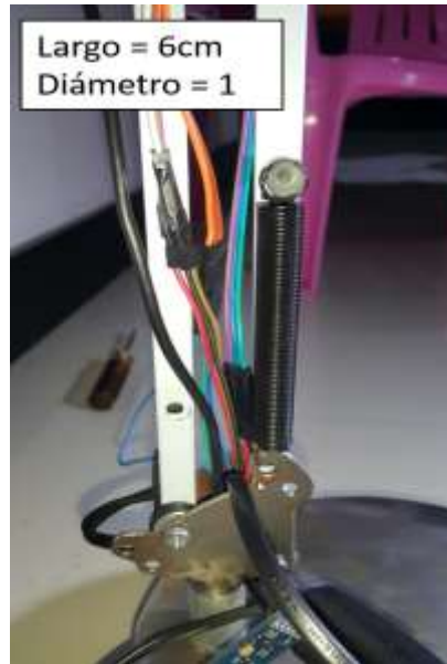
Figura 64. Posicionamiento de resortes y características – Sección 2
