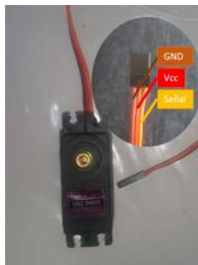
Figura 33. Diagrama de Pines-Servomotor MG946R
