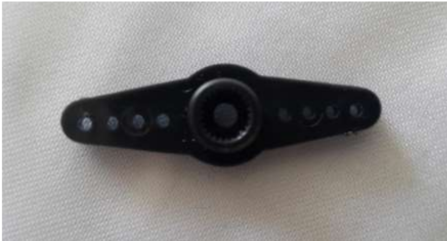
Figura 41. Pieza de sujeción de servomotores Tower Pro MG946R
