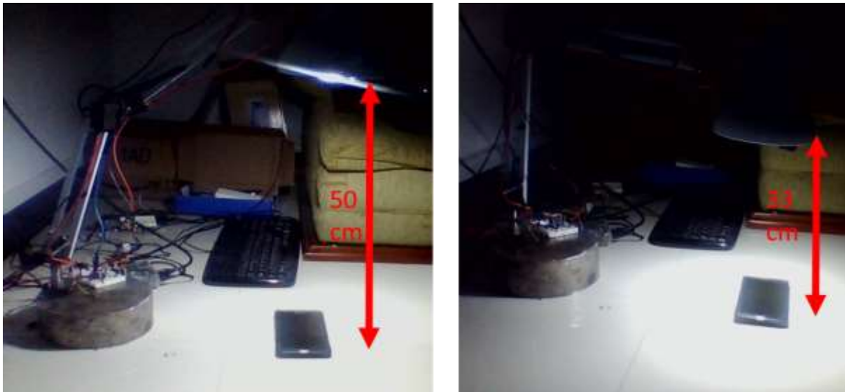
Figura 47. Determinación de iluminancia de fuente lumínica con distancia máxima y mínima al plano horizontal
