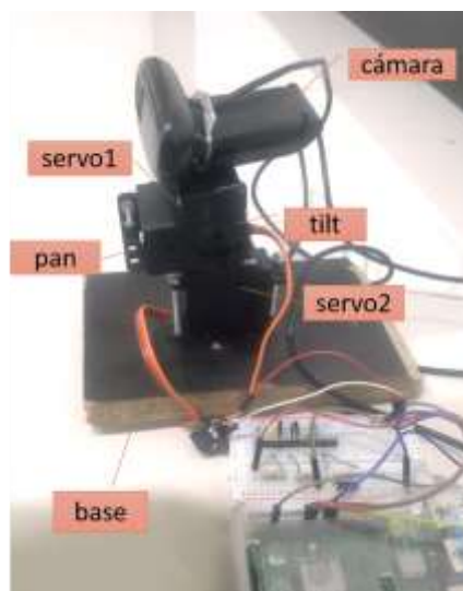
Figura 68. Estructura de prueba de software de seguimiento de objeto por color
