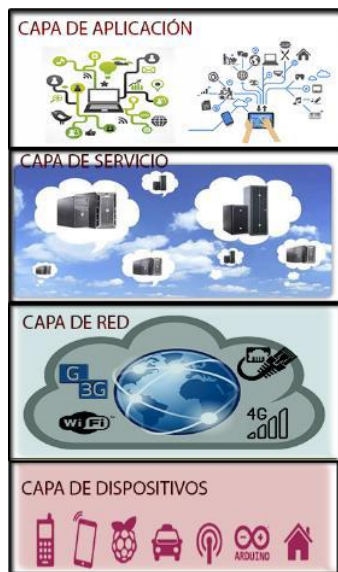
Figura 2. Diagrama del modelo de referencia de la IoT. Fuente: Carrez Francois (2013). Internet of Things – Architecture
