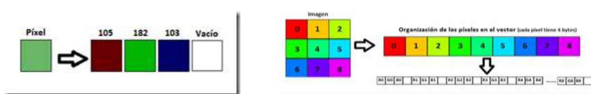
Figura 15: Composición de un píxel y formación de una imagen Fuente: (microsoft, 2011, pág. 1)
