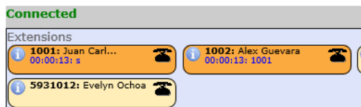
Figura 18: Monitoreo de llamadas en el panel del operador de Elastix
