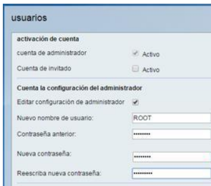
Figura 33 Interfaz de configuración de usuario y contraseña, en el firewall cisco RV.
