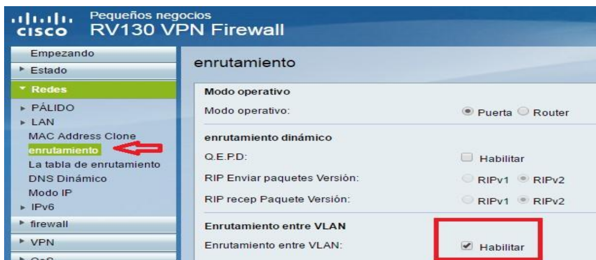
Figura 40 Interfaz de configuración comunicación Inter Vlan.
