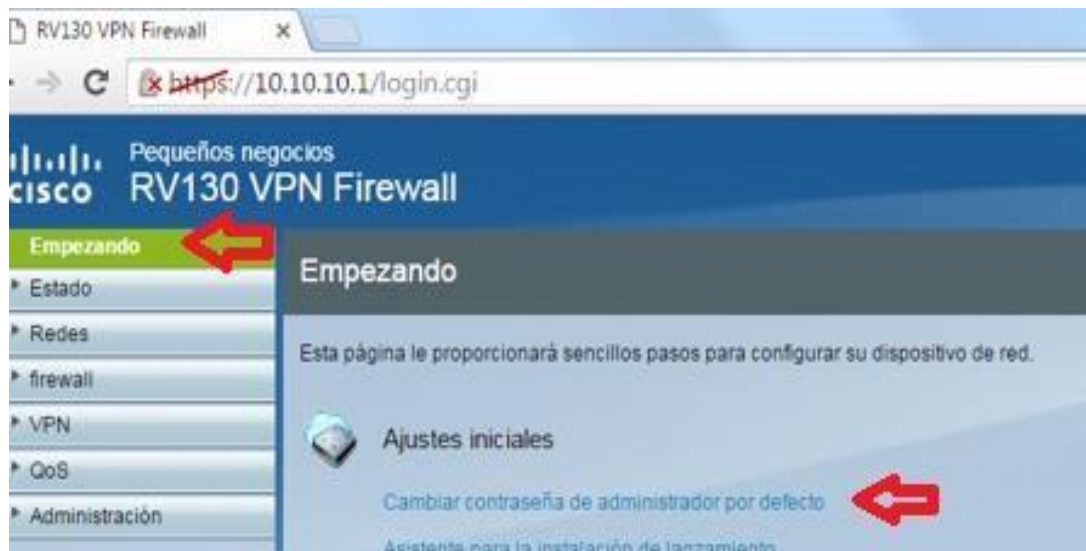
Figura 32 Interfaz para configurar el usuario y contraseña en el firewall cisco RV 130
