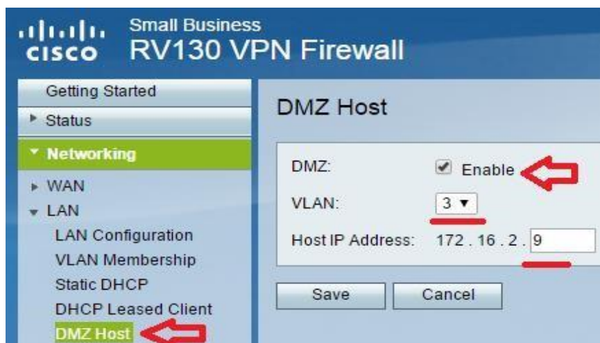
Figura 42 Interfaz de configuración de la DMZ.
