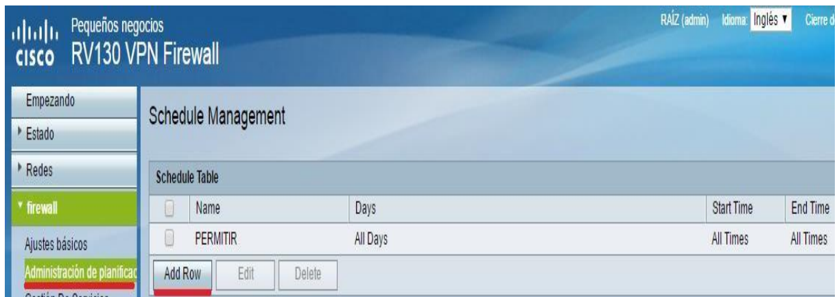
Figura 44 Interfaz del primer paso para crear una nueva ACL
