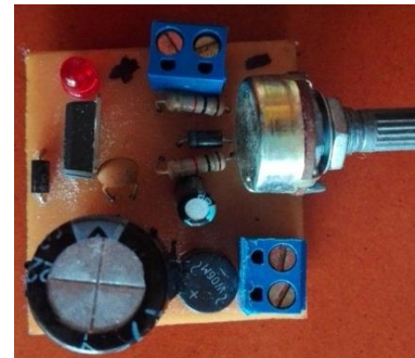
Figura 7. Fuente de voltaje variable para módulo SIM900 De transmisión y recepción
