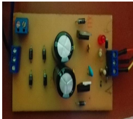
Figura 9. Fuente de voltaje de +/- 15v para el sensor de presión
