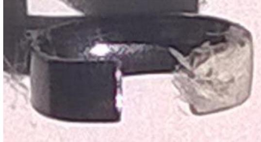
**FIGURA 111:** Acumulación superficie de apoyo
