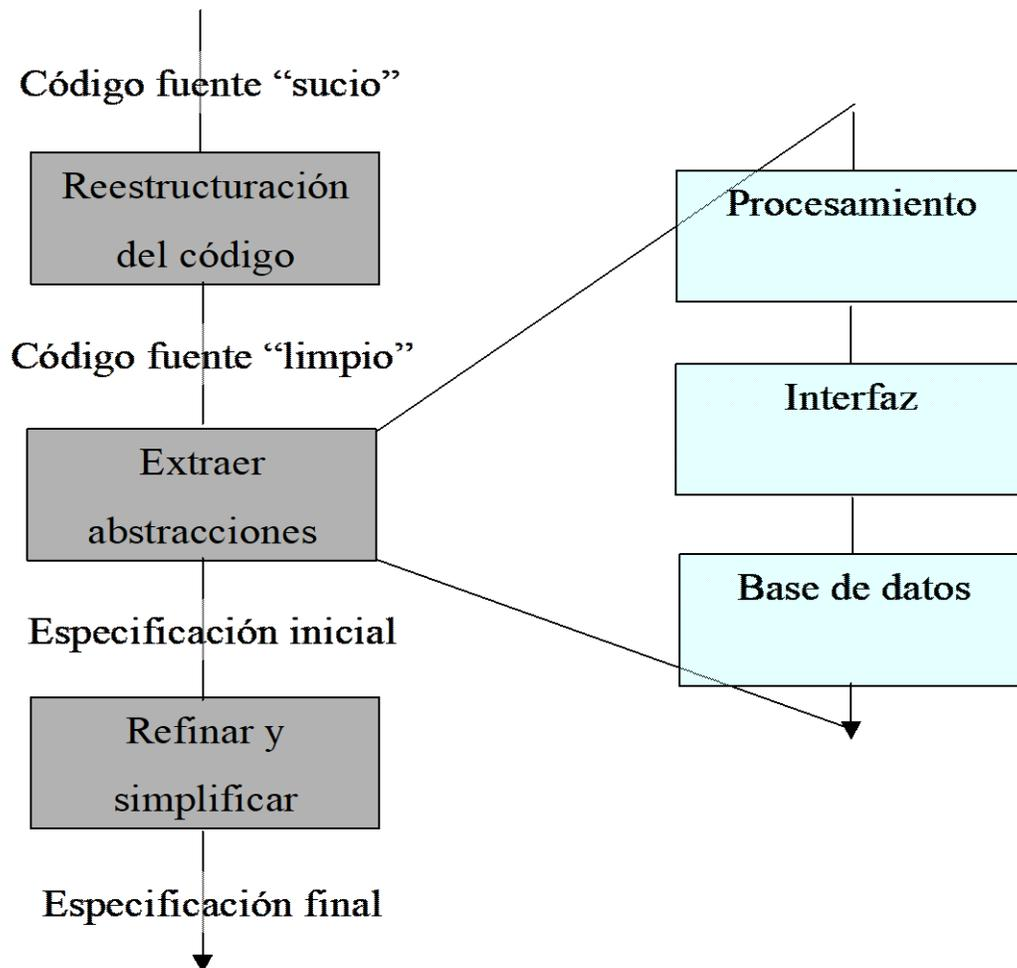
El proceso de la ingeniería inversa se representa en la figura 2.4. Antes de que pueda comenzar las actividades de ingeniería inversa, el código fuente no estructurado (“sucio”) se reestructura para que solamente contenga estructuras de programación estructurada. Esto hace que el código fuente sea más fácil de leer y proporciona la base para todas las actividades de la ingeniería inversa subsiguientes.
