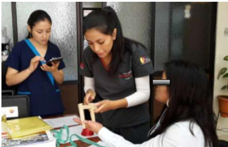
**Fotografía 4** Medición de diámetro de agarre con el cono
