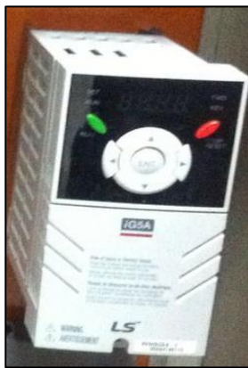
Figura 1.8. Variador de frecuencia
