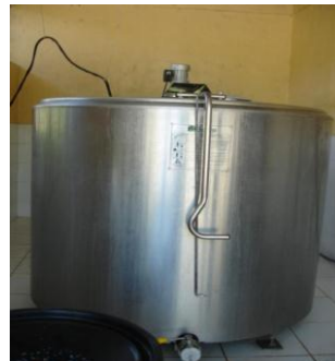
Imagen N a 18: Tanque de enfriamiento
