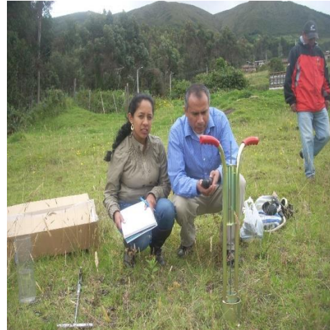
Fotografía 2. Instalación del ensayo infiltrómetro.
