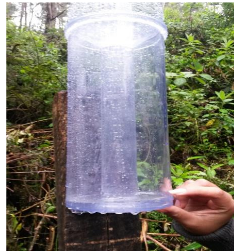
Fotografía 4. Medición en campo pluviómetro.
