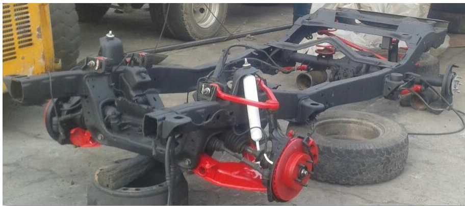
FIGURA 62: Instalación de las suspensiones delantera y posterior al chasis.
