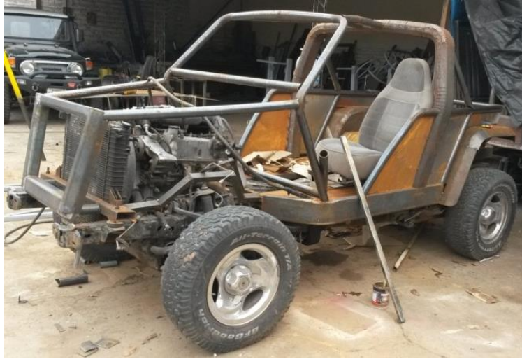
FIGURA 72: Principio de construcción de la carrocería.
