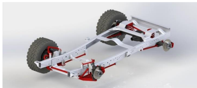
FIGURA 61: Ensamble general del chasis y sus componentes.
