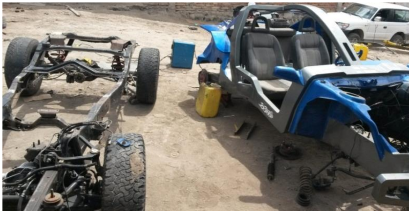
FIGURA 67: Chasis y carrocería del vehículo Peugeot 604 tipo Buggy.
