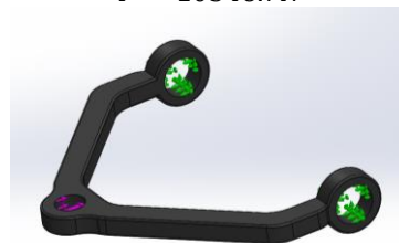
Figura 9. Determinación puntos de sujeción y aplicación de fuerzas. Fuente: (Solidworks, 2016)
