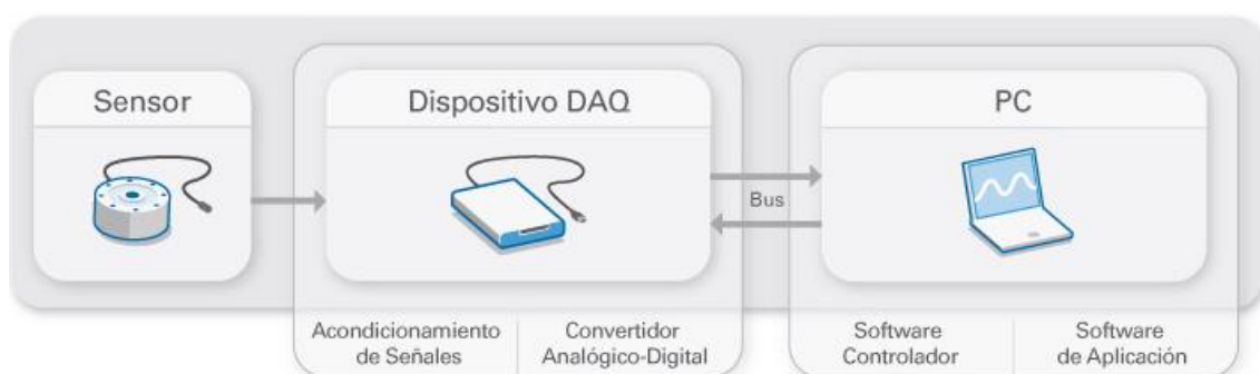
Figura 2.13 Partes de un sistema de adquisición de datos (INSTRUMENTS, 2015).
