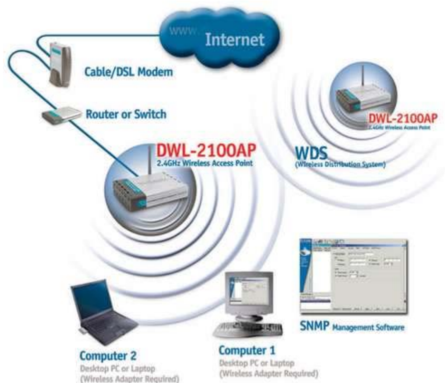
Figura 5.16: Arquitectura del Access Point [www26]:
