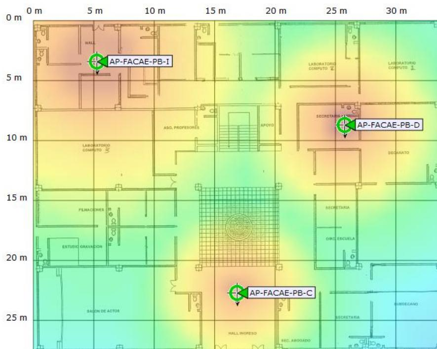
Figura 48.-Cobertura de señal Planta Baja, FACAE.
