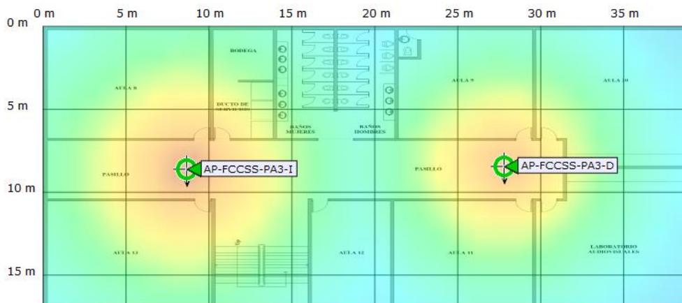
Figura 63.- Cobertura de la señal Planta Alta 3, FCCSS.
