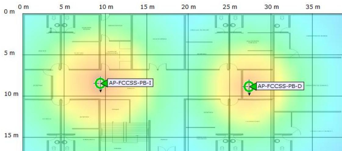
Figura 60.- Cobertura de la señal Planta Baja, FCCSS.
