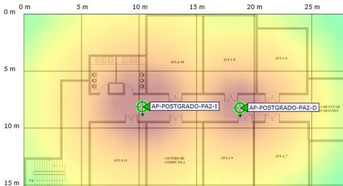
Figura 72.- Cobertura de la señal Planta Alta 1, Postgrado.
