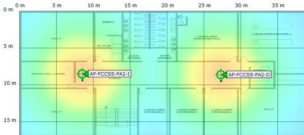
Figura 62.- Cobertura de la señal Planta Alta 2, FCCSS.
