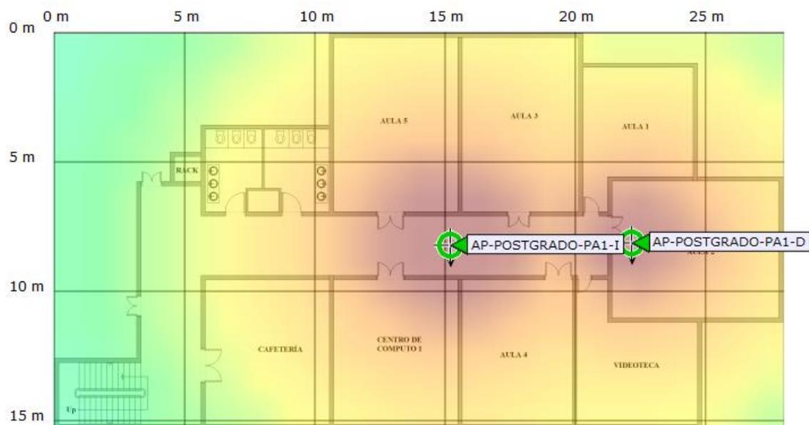
Figura 71.- Cobertura de la señal Planta Alta 1, Postgrado.
