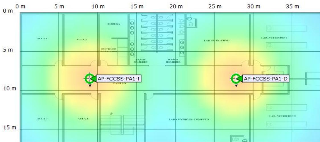
Figura 61.- Cobertura de la señal Planta Alta 1, FCCSS.
