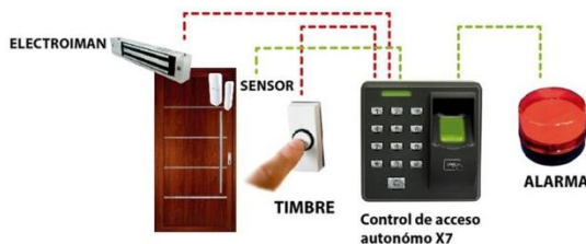
Figura 92. Sistema de control de acceso
