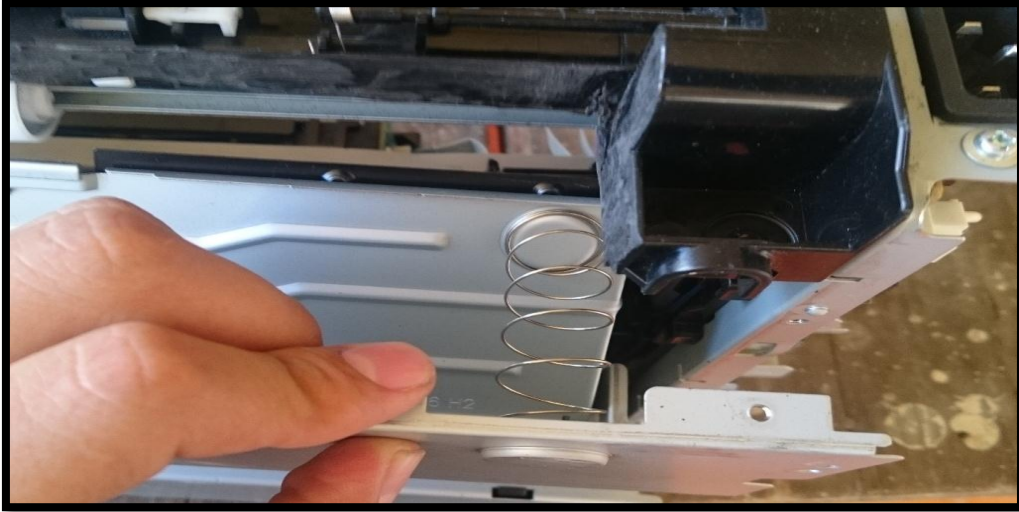
Figura 72. Separación de resortes de la bandeja de entrada.
