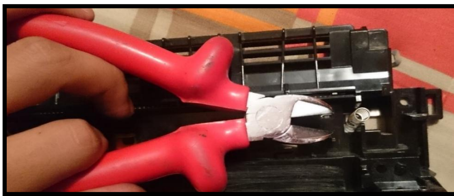
Figura 66. Recorte de resorte que ajusta al rodillo de transferencia.
