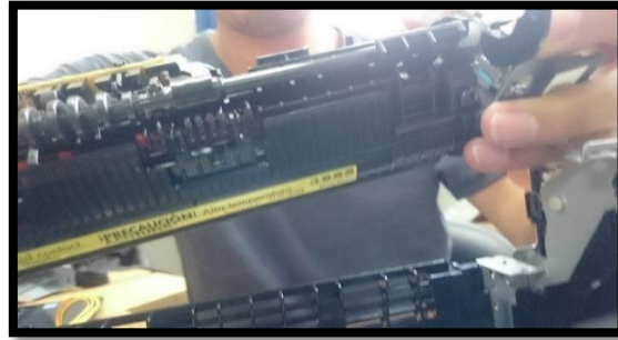
Figura 43. Fusor destornillado y desmontado de un lado.
