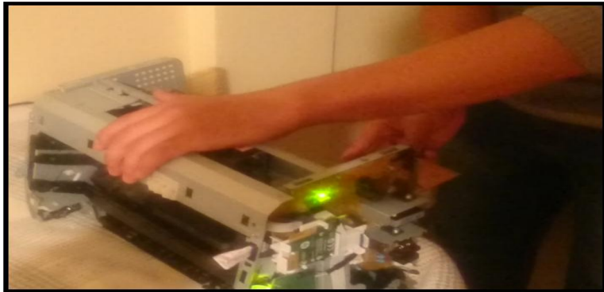
Figura 93. Se ingresa la baquelita de cobre para realizar la impresión del circuito.
