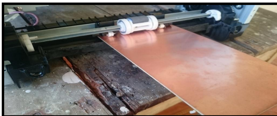
Figura 68. Prueba de ingreso de baquelita de cobre en la base de transferencia.
