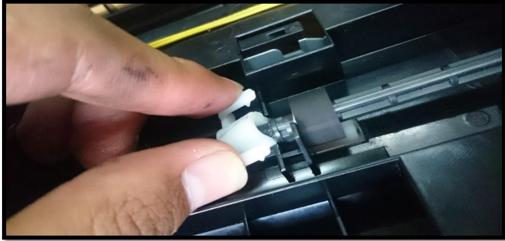
Figura 62. Retiro de seguros de rodillo de ingreso. Fuente. Criterio de diseño con la Impresora HP 1102 W.
