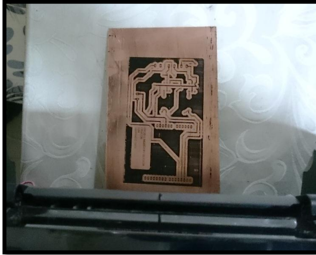
Figura 161. Impresión en baquelita de cobre utilizando la impresora HP 1102 W.
