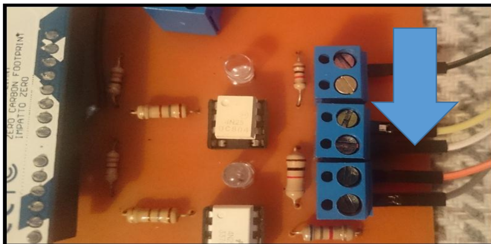
Figura 99. Señal del termistor conectada en serie con la resistencia de 6.8k \Omega .
