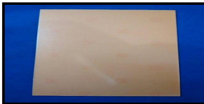
Figura 2. Baquelita de cobre de 12cm x 8cm.
