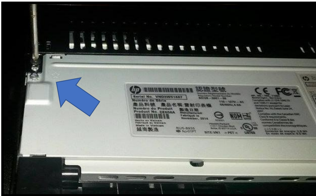
Figura 135. Retirar tornillos parte superior izquierda.
