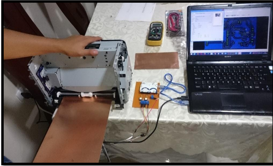
Figura 105. Impresión de prueba con baquelita de cobre de tamaño A4.
