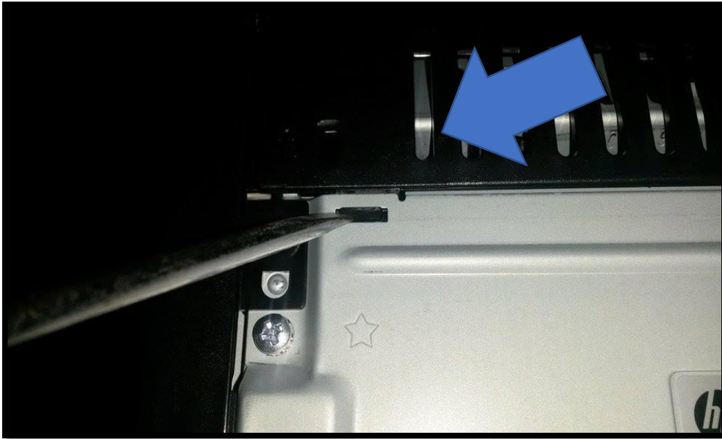
Figura 133. Presión en la guía superior, desajustar soporte.
