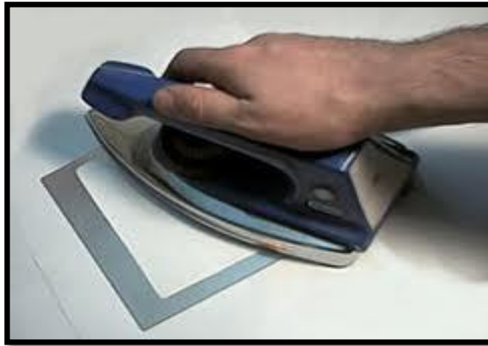
Figura 146. Método de planchado, transfiriendo la tinta del papel transfer a la baquelita de cobre.
