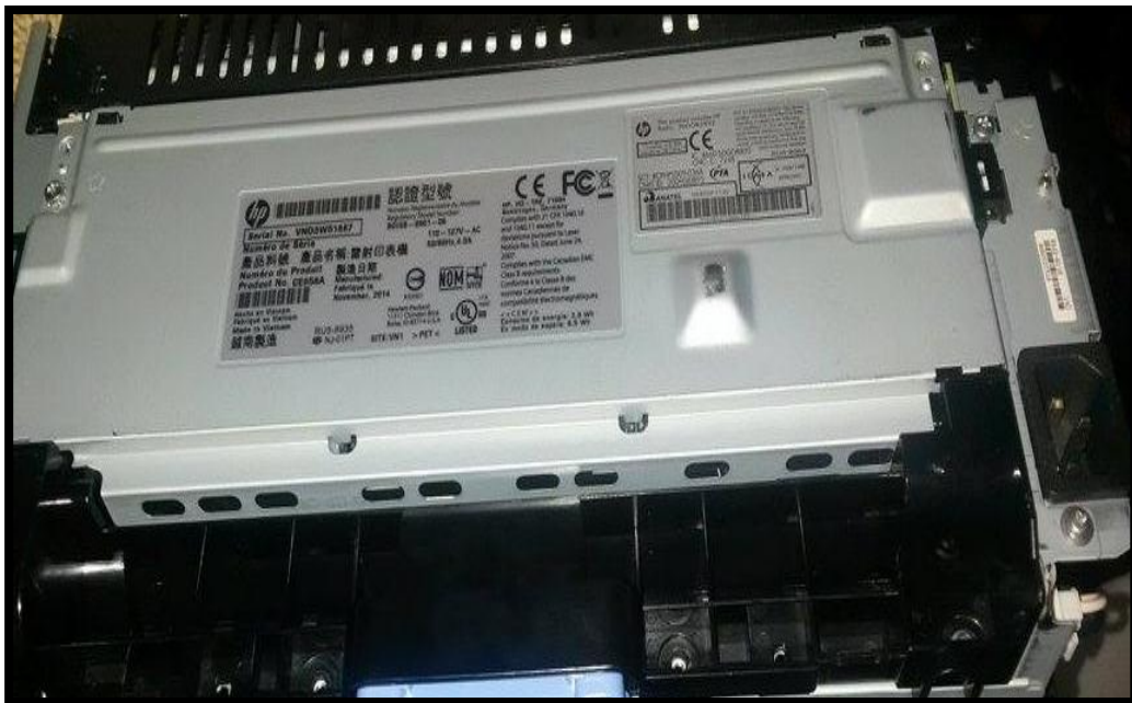
Figura 140. Tapa Trasera, sin tornillos y sin destapar.
