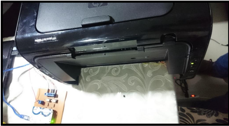
Figura 159. Impresora HP 1102 W lista para realizar impresión en la baquelita de cobre.
