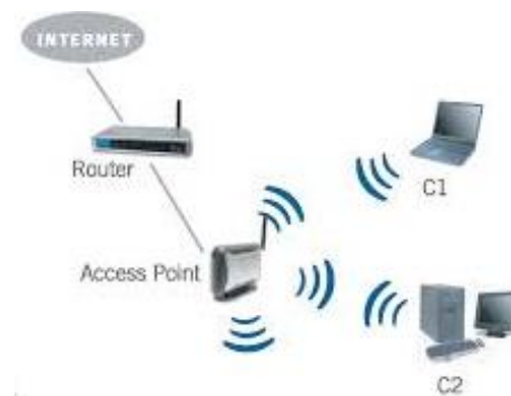
Figura 15. Operación de Access Point
