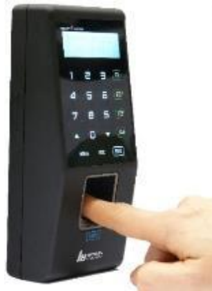
Figura 8. Control de acceso biométrico
