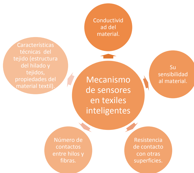
Ilustración 8: mecanismos de sensores dentro de los textiles inteligentes de tercera generación.
