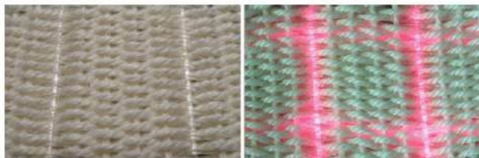
Figura 29: Tejido fabricados con sensores de fibras ópticas.
