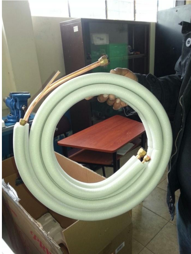
Figura 24: Cañerías de cobre 1/4" y 5/8". Fuente. Foto tomada por el investigador (2015).
